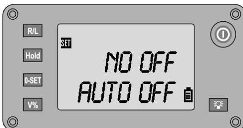
Включение/выключение функции автоматического отключения прибора
